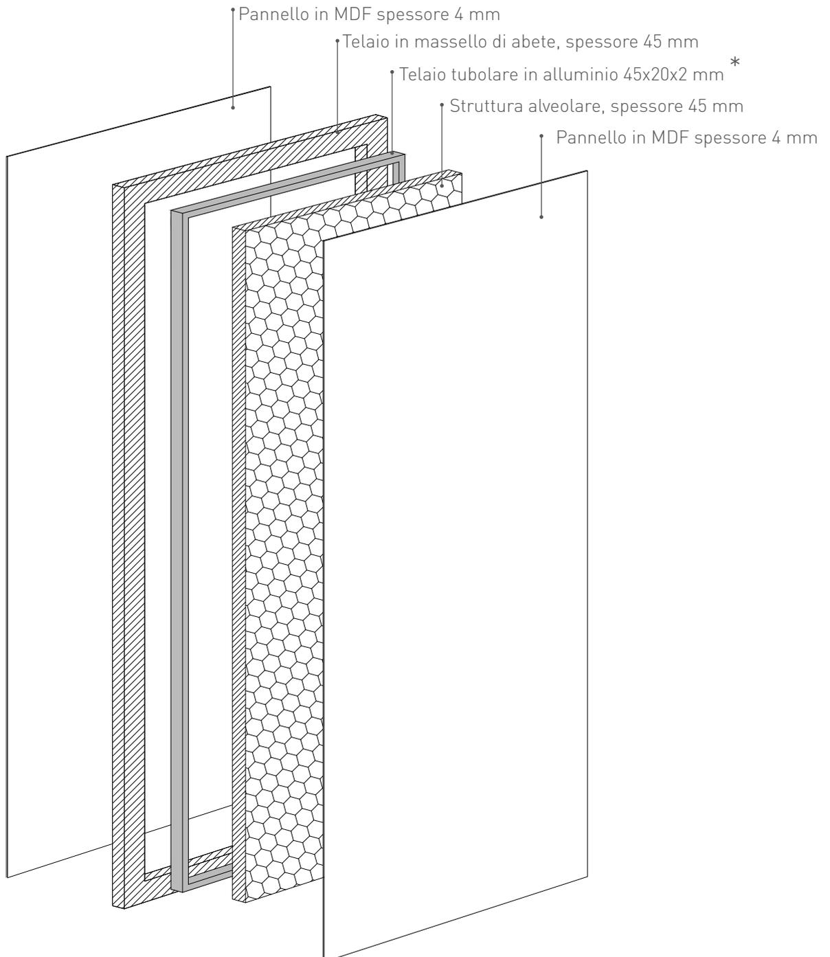
\* Il telaio tubolare in alluminio garantisce la perfetta planarità delle porte di grandi dimensioni e viene installato solo su pannelli anta fuori misura di **larghezza superiore a 85 cm** e/o **altezza superiore ai 225 cm**.
