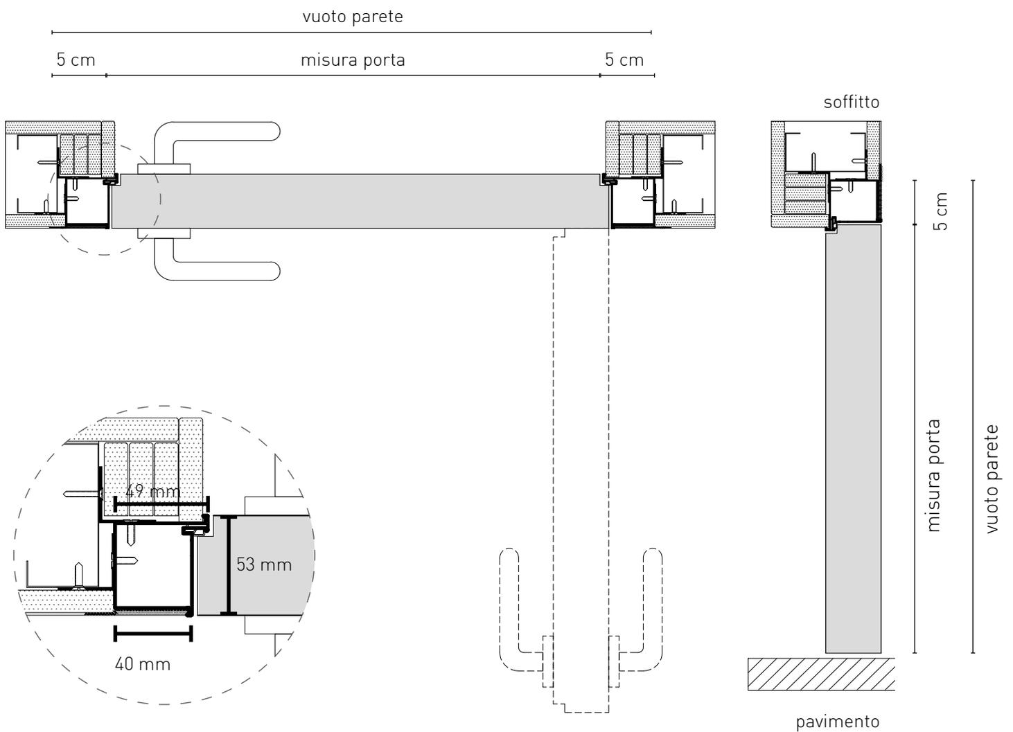
Le misure d'ingombro massime esterne del telaio (vuoto parete necessario) sono +10 cm in larghezza e + 5 cm in altezza, rispetto alla misura della porta che definisce il passaggio netto.
